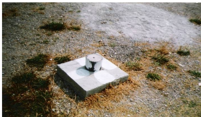
Slika 1.3. Način stabilizacije tačaka državne referentne GPS mreže.
