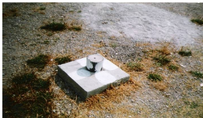
Slika 1.3. Način stabilizacije tačaka državne referentne GPS mreže.
